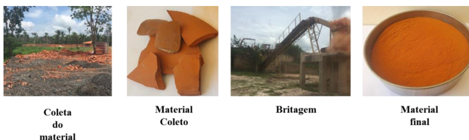
Figura 32. Processo de obtenção da cerâmica vermelha.
