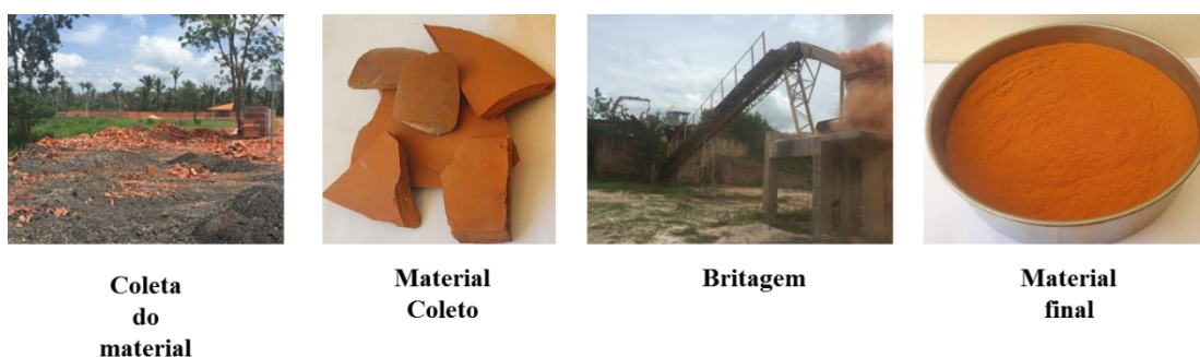
Figura 20. Processo de obtenção da cerâmica vermelha.
