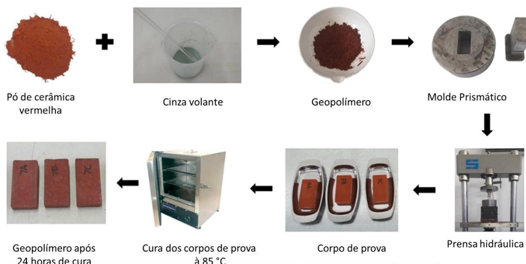
Figura 7: Processo de preparação esquemática das amostras.
