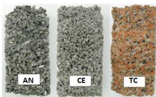
Figura 14: Corpos de prova de concreto permeável geopolimérico com agregado natural (NA), concreto estrutural (CE) e tijolo cerâmico (TC).
