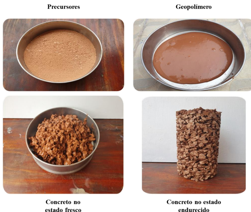
Figura 33. Processo de produção do concreto permeável geopolimérico.
