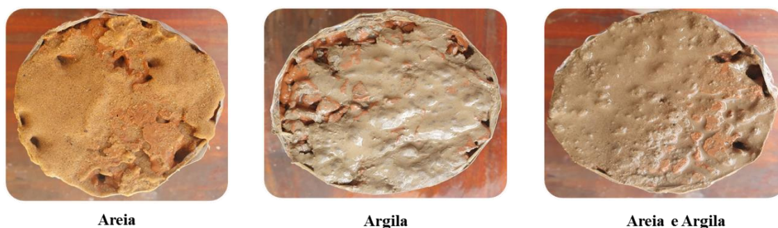
Figura 42. Acúmulo de sedimentos após ensaio de colmatção nos corpos de prova.
